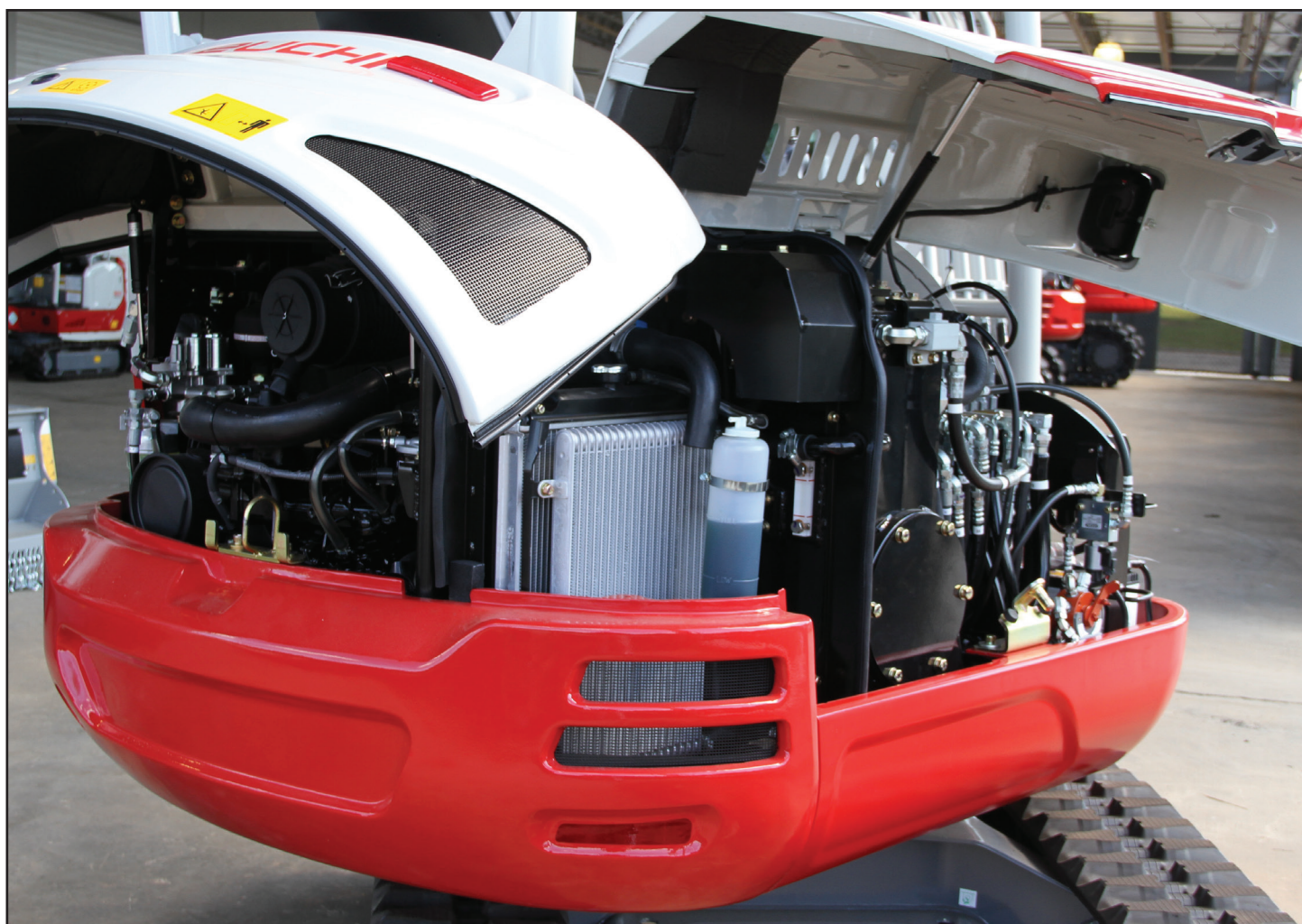
Les grands capots de service verrouillables offrent une protection contre le vandalisme et un accès de maintenance exceptionnel.
